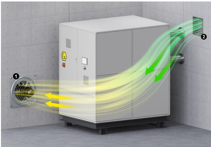
Beispielhafte Lüftung einer Kälteanlage mit brennbarem Kältemittel
